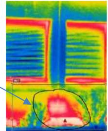
**Pour augmenter la température de 8.9° de 0,4 m<sup>3</sup> du mur extérieur se trouvant derrière chaque niche de chauffage non isolée, le jour de thermographie :**
